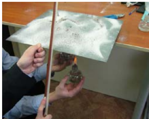
Рис. 2 Фигуры Хладни на нагретом металлическом листе
